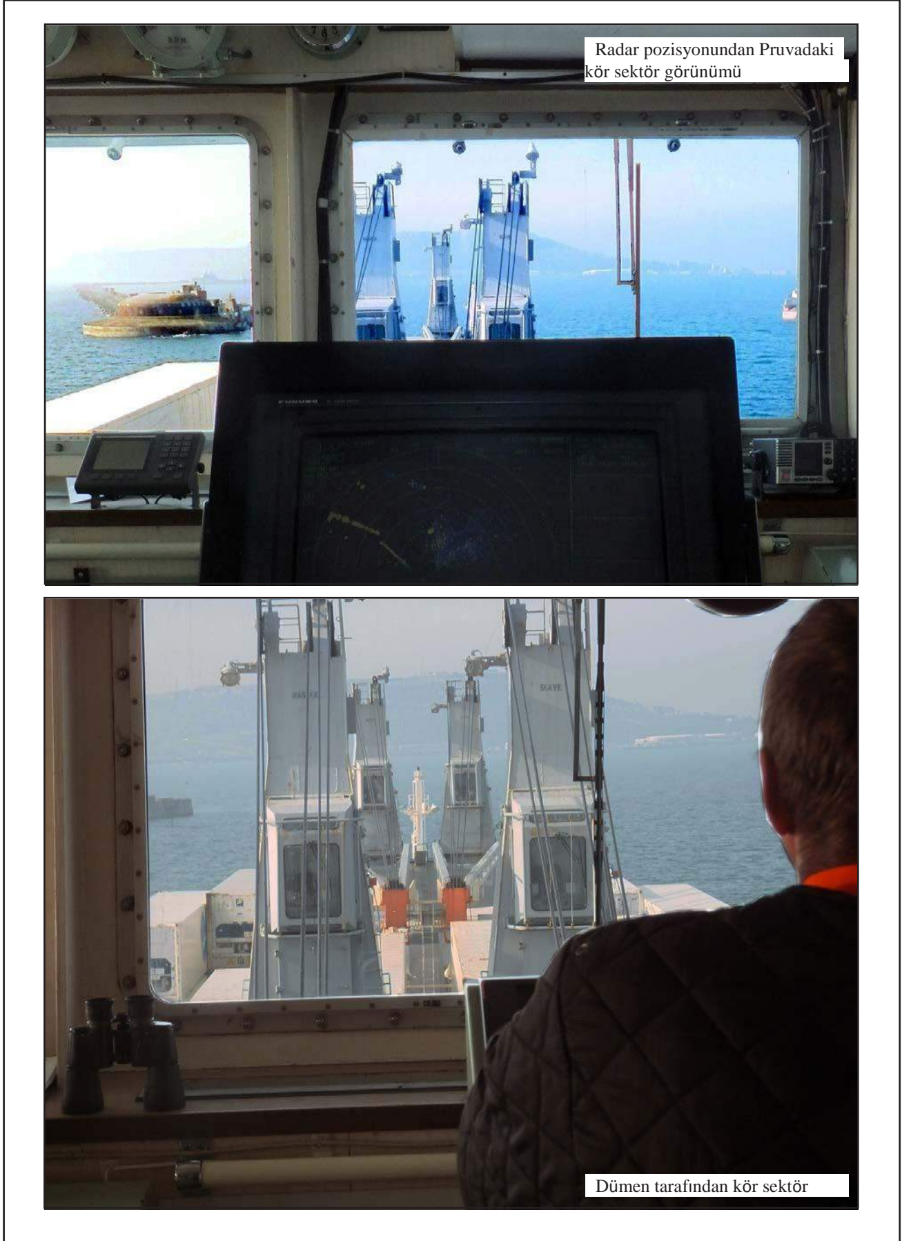
Resim 4: Genel yük gemisinin dümen ve radar pozisyonundan Kör Sektör Görüşü
