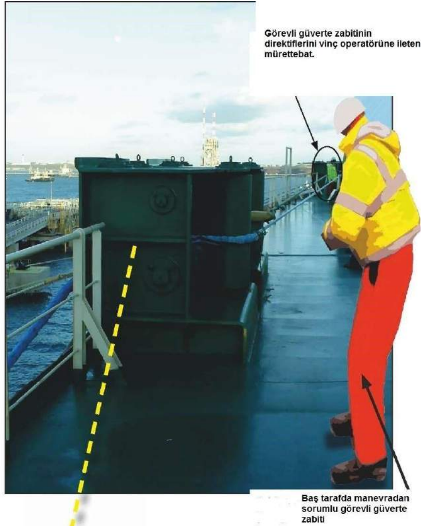
Figür 3: Baş taraf manevra ekibi Sorumlu Güverte Zabiti, iskele baş omuzluk panama loçası yakınında resimdeki gibi pozisyon almıştır.
