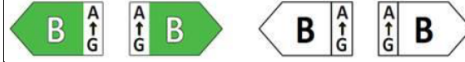
Şekil 1: Enerji Verimliliği Sınıflarının Aralığı ile Belirtilen Renkli / tek renk , Sol / Sağ Ok Tasarımı
